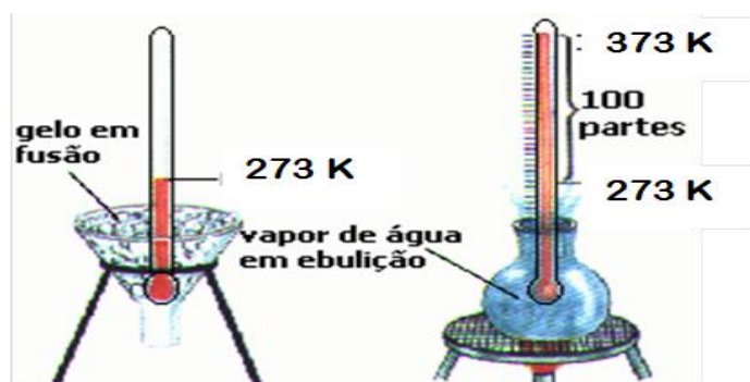
Figura 20 - Imagem representando o ponto de fusão, ebulição da água em (K) e o intervalo entre os pontos fixos.
